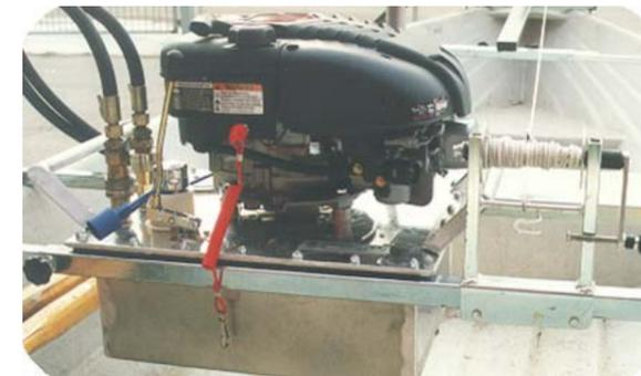
**Hyddo 200** устанавливается отдельно и легко снимается. Выхлоп через удлиненную выхлопную трубу выходит в стороне от водительского сидения. Все гидравлические элементы защищены кожухом, что предотвращает утечку масла. Двигатель можно завести с водительского сидения. **Hyddo 200** используется для **Mod 3070** и **Hymo**. **Hyddo 200** может поставляться дополнительно к другим гидравлическим машинам.
