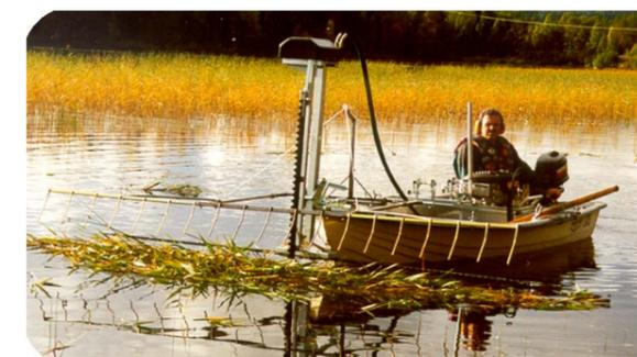
Грабли, установленные спереди, используются в сочетании с **Dorocutter Mod 3070**. Грабли делают устройство **Dorocutter** завершенным, и очистка водоемов становится более эффективной.
