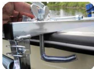
Крепление косилки осуществляется при помощи трубки. Все рамы - выдвижные, и подходят для лодок различной ширины.
